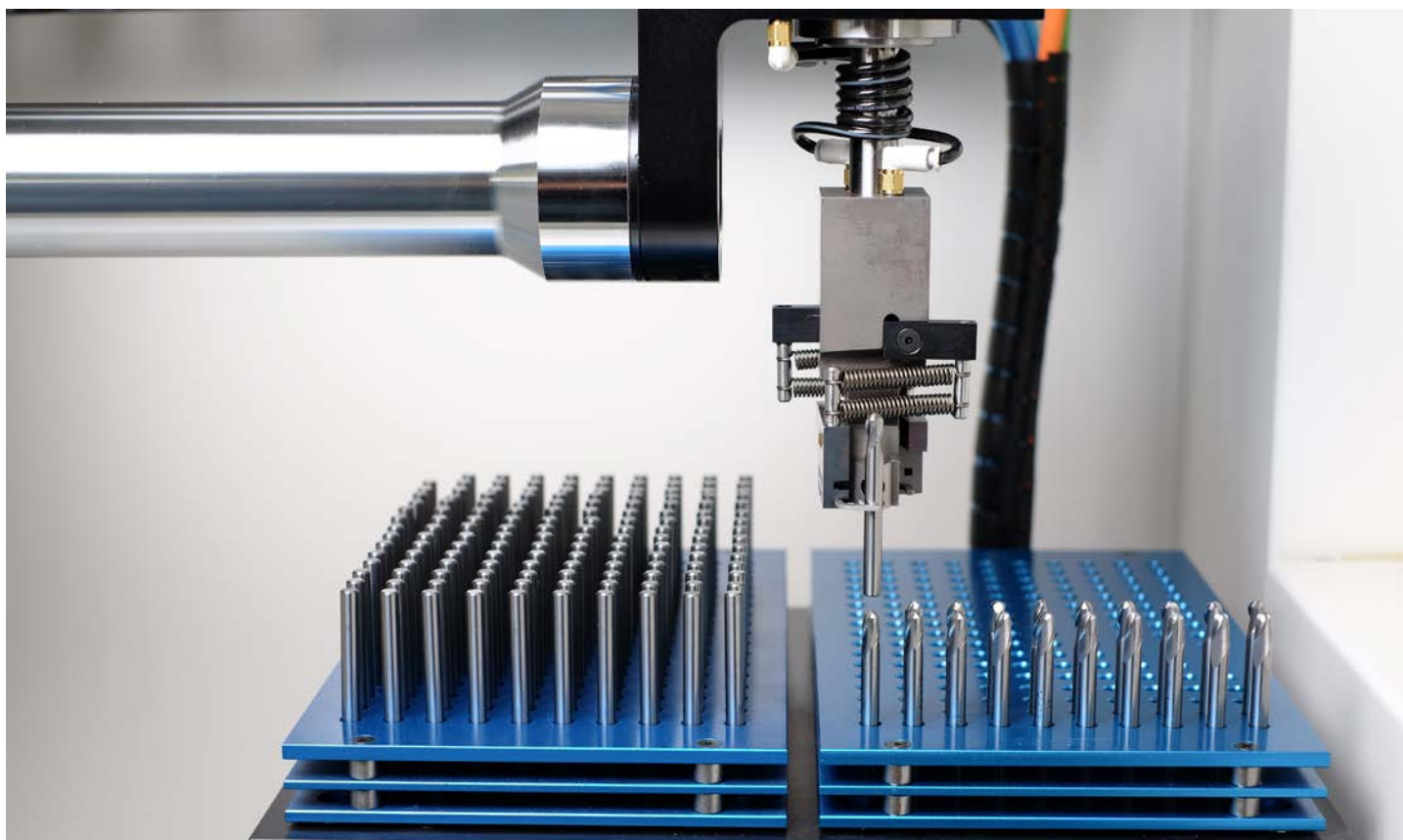
Fig. 6 Particolare dei pallett portapezzi prima e dopo la lavorazione
